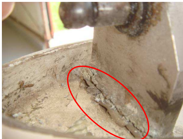
Fig. / Abb. 3 Flaking Abplatzungen
